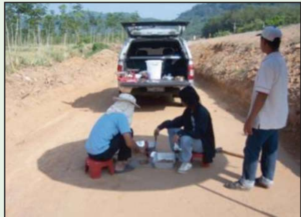
รูปที่ 4-19 ทดสอบความแน่น ของงานดินถมแต่ละชั้น
