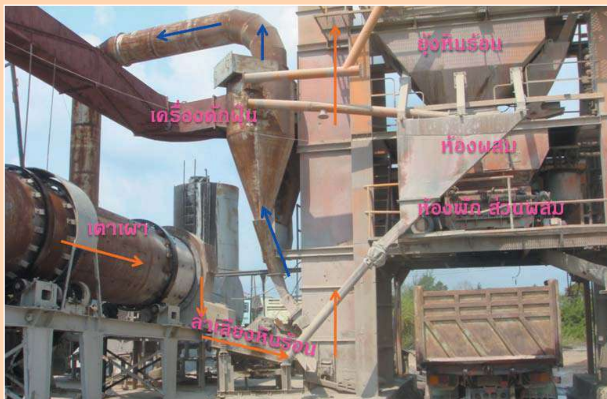
รูปที่ 6-18 รูปแสดงการทำงานของโรงผสม
