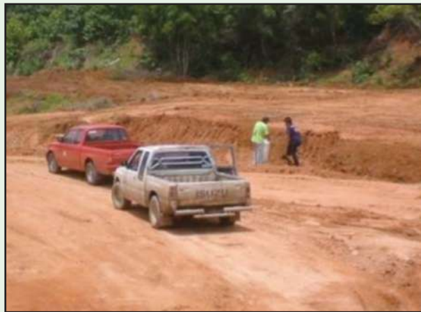
รูปที่ 4-11 การเก็บตัวอย่างวัสดุจากแหล่งเพื่อทดสอบคุณสมบัติ (General Test)
