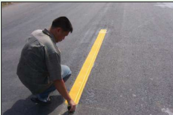
รูปที่ 7-12 การเก็บตัวอย่างเพื่อตรวจสอบคุณภาพสี
