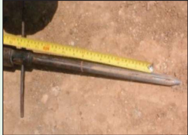
รูปที่ 4-35 การใช้เหล็กเจาะ เพื่อตรวจสอบความหนาชั้นวัสดุ
