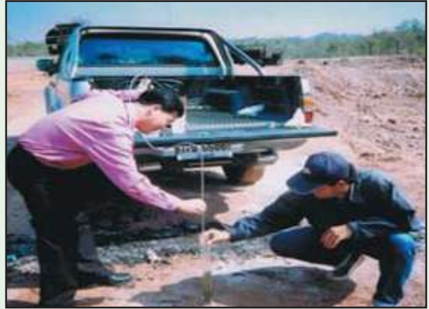
รูปที่ 3-10 การทดสอบคุณสมบัติหินฝุ่น โดยวิธีหาค่าสมมูลย์ของทราย
